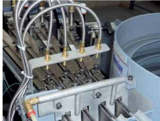
Les capteurs contrôlent et régulent le stockage des goujons dans les circuits d'alimentation.
