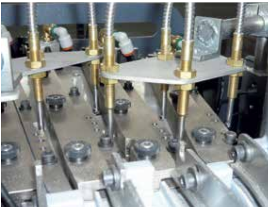
Les capteurs contrôlent et régulent le stockage des écrous dans les circuits d'alimentation.
