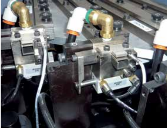
Un écrou est soufflé à la fois à partir du tiroir d'injection dans l'outil et est installé ultérieurement.
