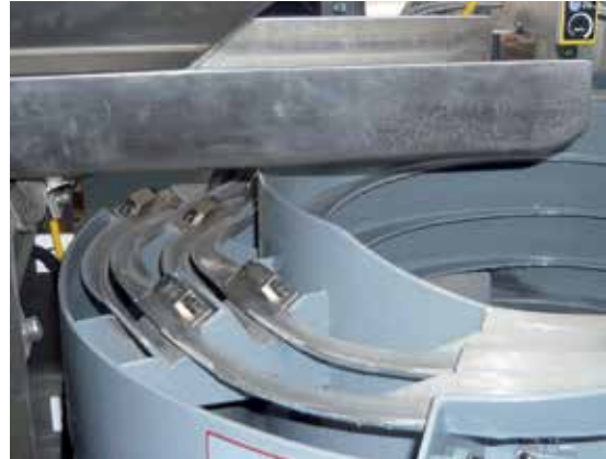
Les écrous sont triés par le trieur dans la bonne direction pour l'installation.
