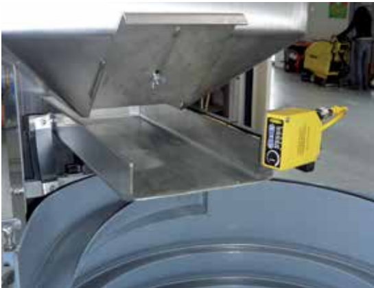
La trémie, également contrôlée par capteur, garantit un niveau constant dans le bol vibrant.
