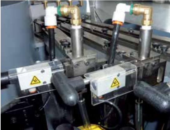
Un goujon est soufflé à la fois par le tiroir d'injection dans l'outil et est installé ultérieurement.
